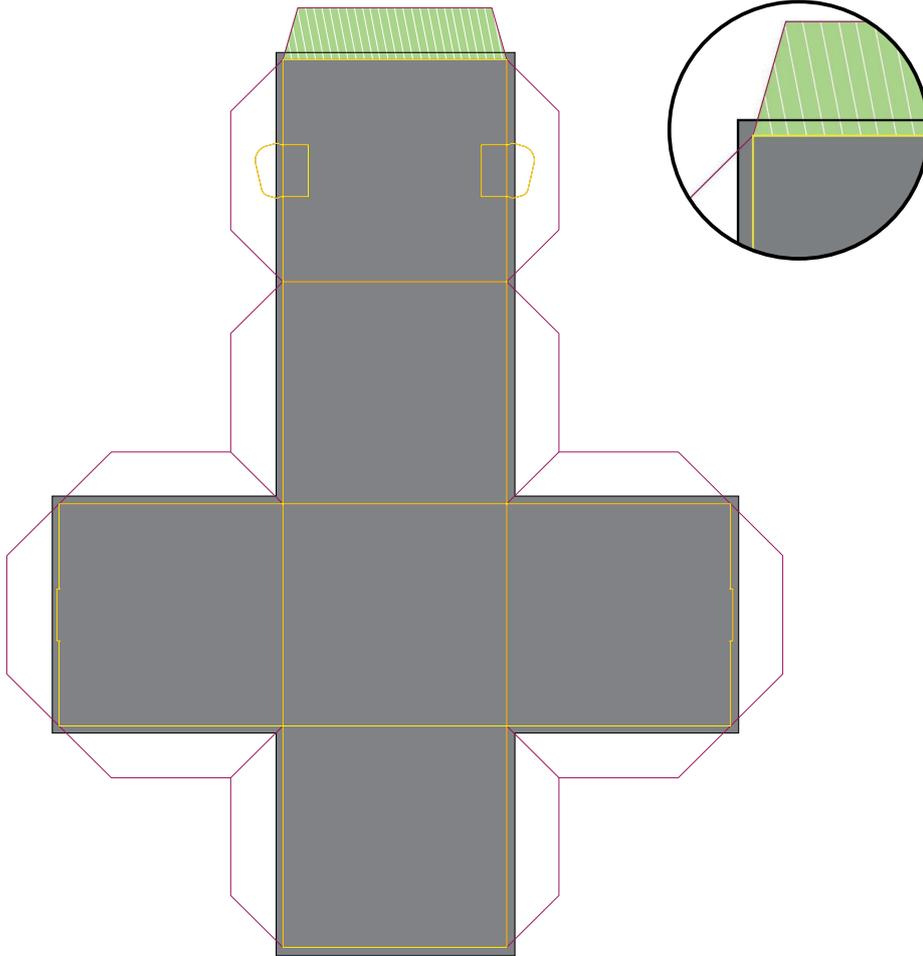
**Falzkante:** Hier werden die Druckdaten nach dem Druck gefalzt.
